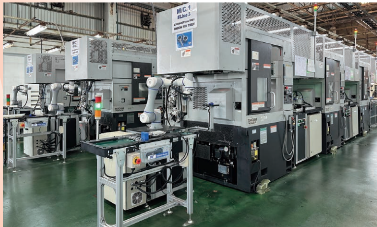
生産ラインは3本新設。それぞれのラインに3台のNC自動旋盤が組み込まれる
